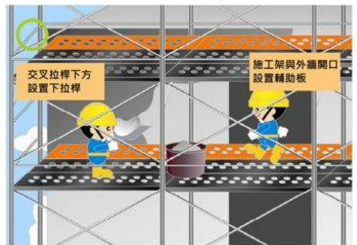
三、施工架應設置安全上下設備供勞工使用，不可攀爬施工架交叉拉桿。
